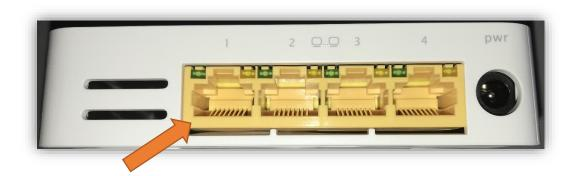
Nun kann der FiberTwist am Anschluss "LAN 1" per Netzwerkkabel mit dem Router verbunden werden
