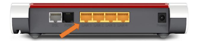
Verbinden Sie nun das andere Ende des Netzwerkkabels mit dem Router.
