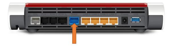
Verbinden Sie nun das andere Ende des Netzwerkkabels mit dem Router.
