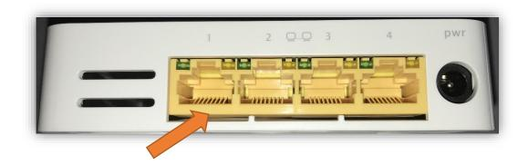
Nun kann der FiberTwist am Anschluss "LAN 1" per Netzwerkkabel mit dem Router verbunden werden
