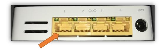
4. Das andere Ende des Netzwerkkabels wird folgendermaßen an den Router angesteckt:
