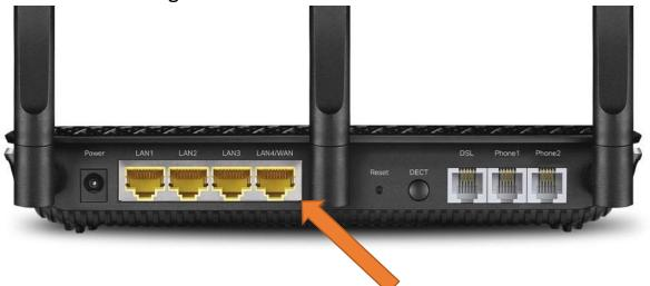
Verbinden Sie LAN 1 am FiberTwist mit LAN 4 des TP-Link-Routers.
